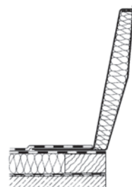
Podstawa stalowo-aluminiowa JET z funkcją oddymiania, typ RAK, o wys. 30 cm. Przykład przyłączenia: bitumiczne pokrycie dachowe
