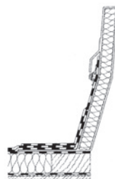
Podstawa JET GFK-RAK do oddymiania opcjonalnie z kołnierzem z żywicy poliestrowej GFK
