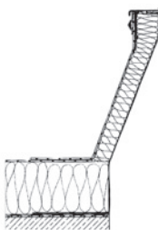
Podstawa stalowa JET typ TE, o wys. 40 cm, z szyną zaciskową. Przykład przyłączenia: pokrycie dachowe z tworzywa sztucznego PVC
