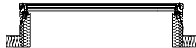
JET SKYSIGHT na podstawie JET ISO-THERM stromej; zastosowanie przy wystarczającym pochyleniu dachu
